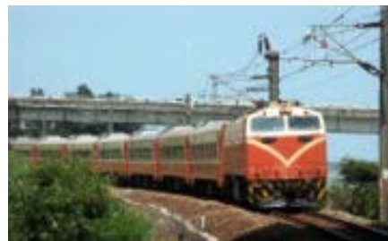
E200型電力機車牽引的莒光號列車
