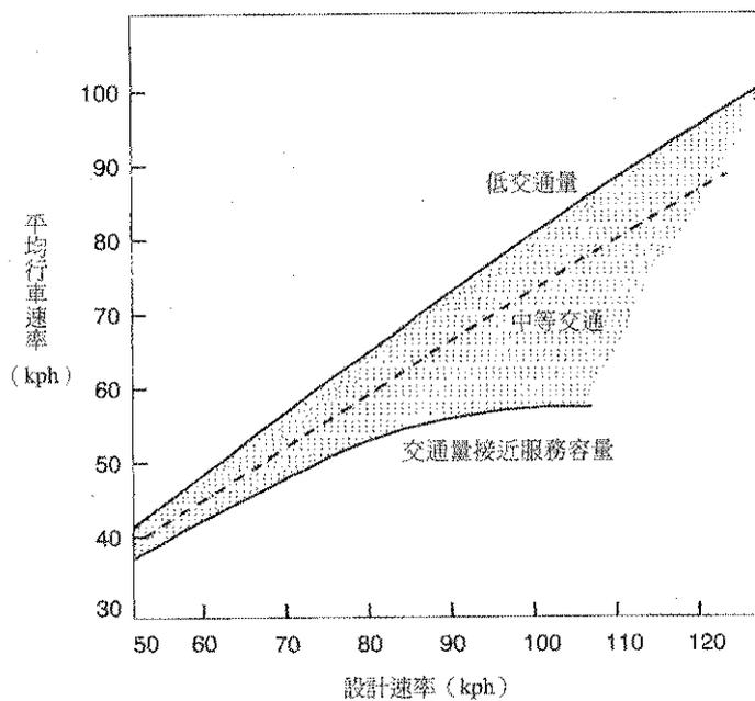
圖 8-2 平均行車速率與設計速率、交通量之關係曲線圖
