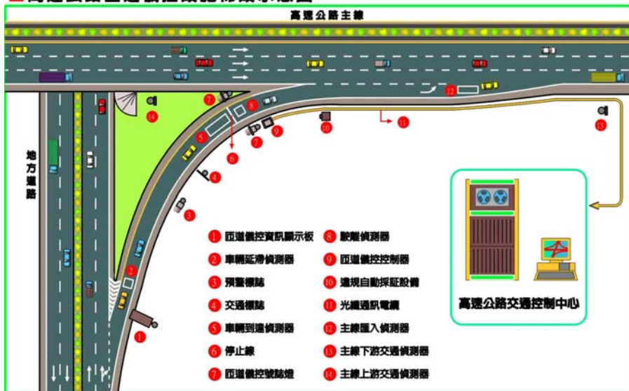
■ 高速公路匝道儀控設施佈設示意圖
