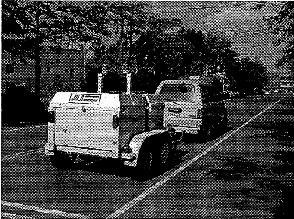
圖 3.18 JILS-FWD 現場撓度試驗圖 (一)
