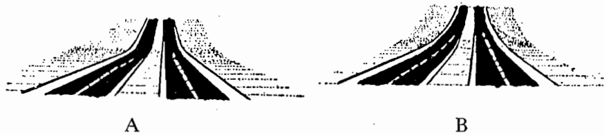
圖八~11 豎曲線長度在三度空間上的視感效果
