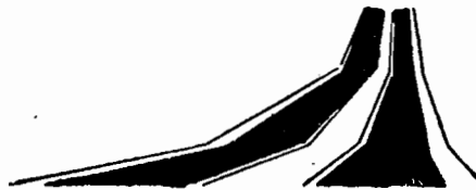
圖八~12 兩凹形豎曲線間之切線太短
